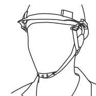
Barbuquejo de 3 puntos de apoyo, obligatorio para trabajos en altura.
